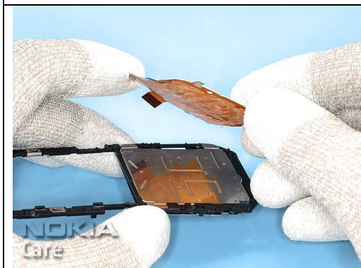
15. 取下排线并且废弃不能再次使用，清除残余胶贴。
